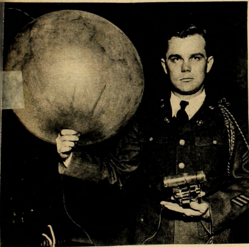
APARATO TRASMISSOR, EN MINIATURA, QUE, UNIDO A UN GLOBO LLENO DE HIDROGENO PERMITE A UN OBSERVADOR METEOROLOGICO SEGUIR LA RUTA DEL GLOBO Y ANALIZAR LOS DIVERSOS CAMBIOS DEL VIENTO Y CONDICIONES ATMOSFERICAS
