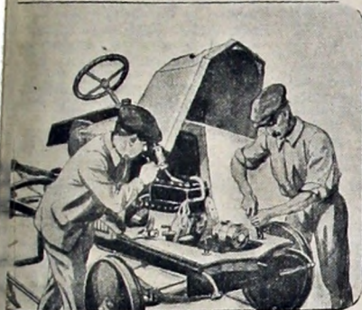
11. Un obrero monta las juntas de goma de la circulación del agua y el otro las grampas que han de servir para cerrar el capot
